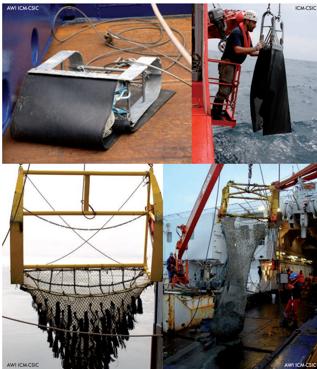
Fig. 7. (↑) Patí epibentònic sobre la coberta d'un vaixell oceanogràfic, i (dreta) a punt de ser introduït dins l'aigua; i (↓) xarxa d'arrossegament Agassiz essent hissada per ficar-la dins l'aigua amb l'objectiu d'obtenir mostres del bentos, i tornant plena de mostres a coberta (dreta).
