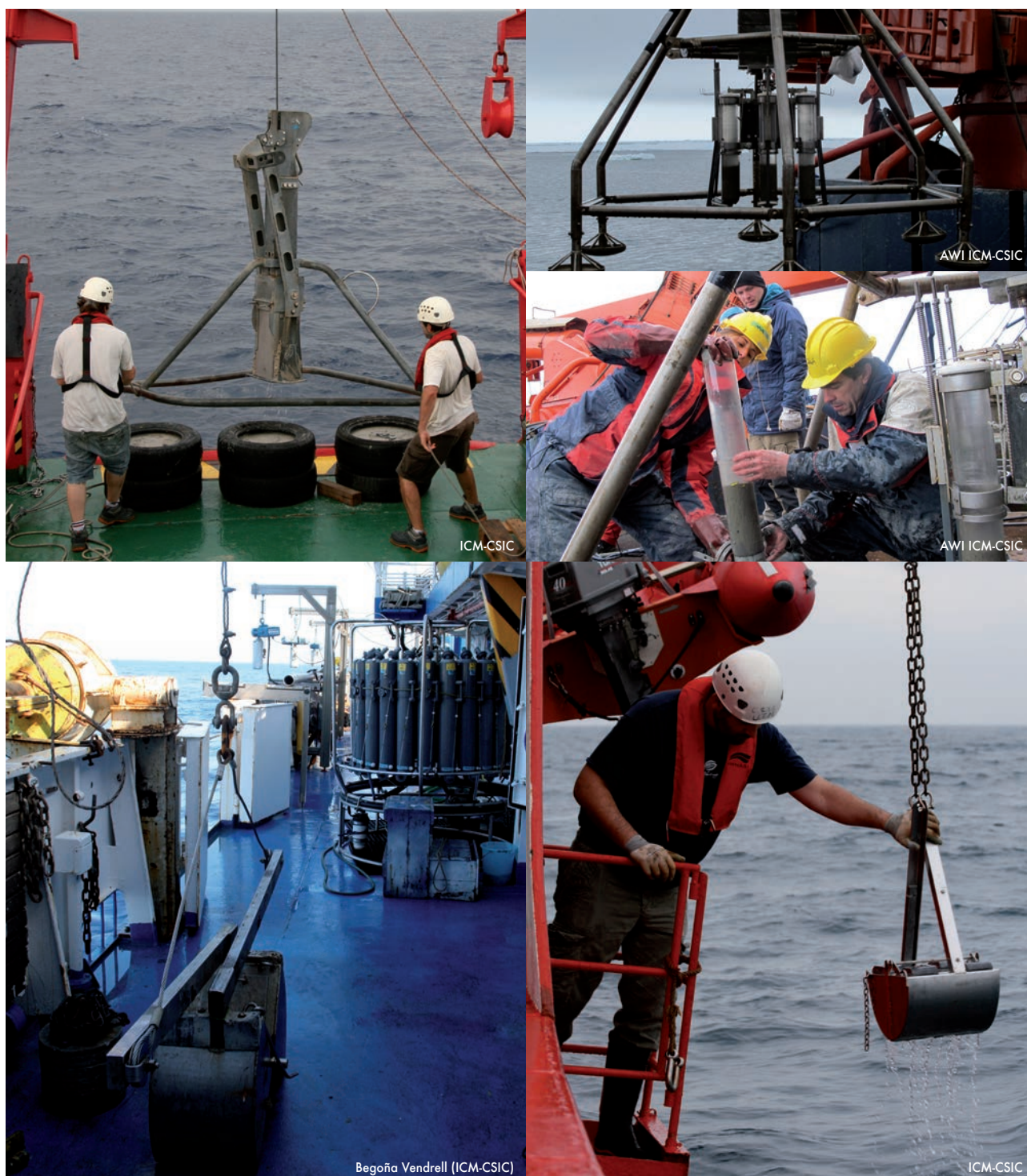
Fig. 6. (↑) Els corers permeten obtenir mostres de sediment. En alguns, l'aparell mostrejador té forma cilíndrica, i en d'altres, com el box corer , és un rectangle metàl·lic. (↓) Draga Van Veen en primer pla, sobre la coberta de treball d'un vaixell oceanogràfic (també es pot observar la roseta al fons); draga Van Veen a punt de ser recollida després d'un mostreig del fons marí.
