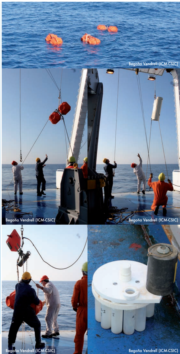
Fig. 4. (←) Esquema del desplegament d'un ancoratge dins l'aigua. (→) Etapes de recuperació d'un ancoratge: primer s'albiren les boies, i posteriorment es van recollint els aparells sobre el vaixell (trampa de sediment, correntímetre). Podeu veure un detall del tambor per a la recollida de diferents mostres del sediment que va caient en la columna d'aigua.
