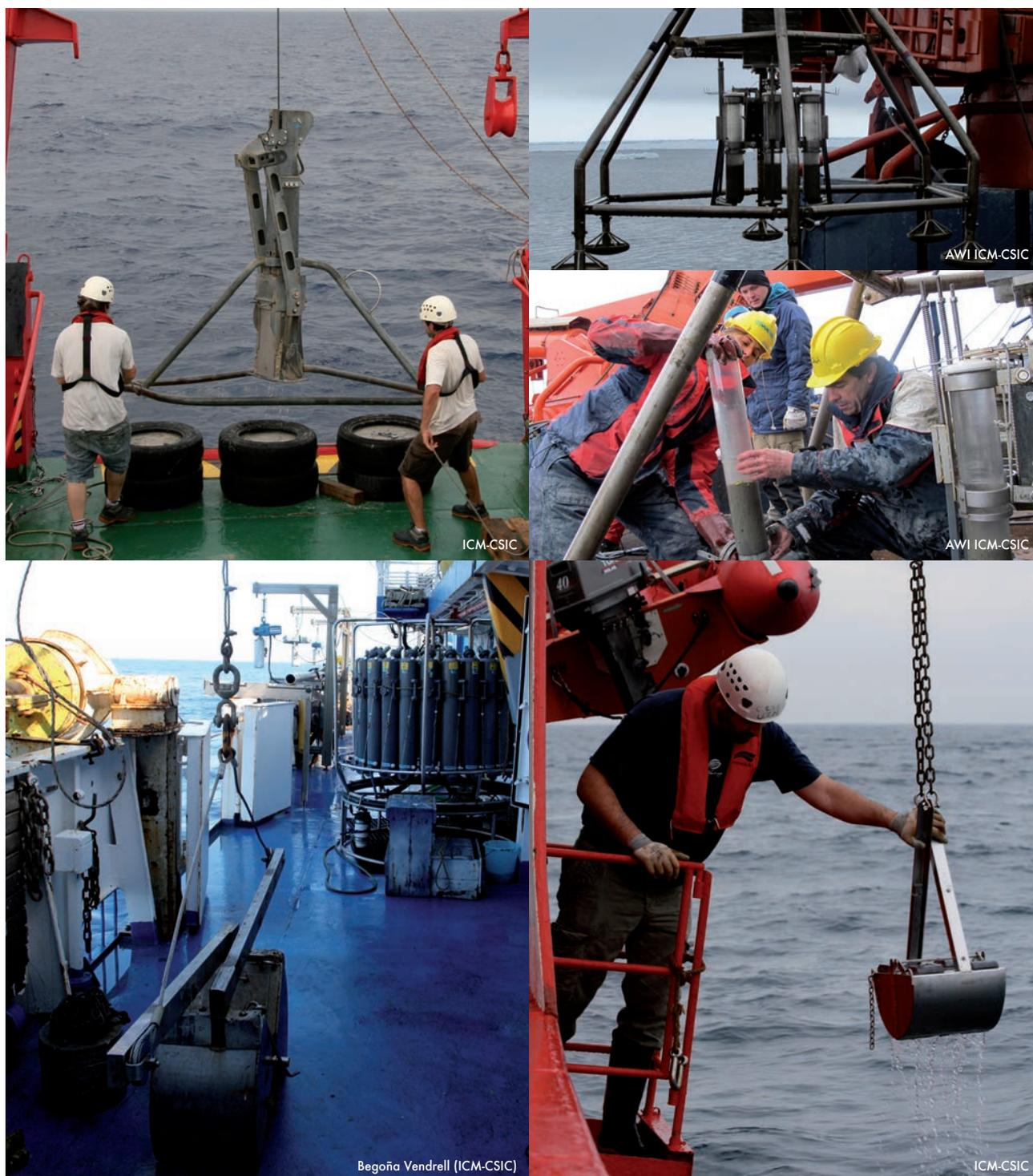
**Fig. 6.** (↑) Los *corers* permiten obtener muestras de sedimento. En algunos, el aparato de muestreo tiene forma cilíndrica, y en otros, como el *box corer*, es un rectángulo metálico. (↓) Draga Van Veen en primer plano, sobre la cubierta de trabajo de un barco oceanográfico (también se puede observar la roseta al fondo); draga Van Veen a punto de ser recogida después de un muestreo del fondo marino.
