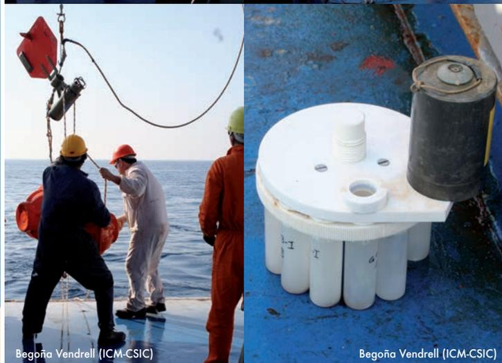
**Fig. 4.** (←) Esquema del despliegue de un anclaje dentro del agua. (→) Etapas de recuperación de un anclaje: primero se divisan las boyas, y posteriormente se van recogiendo los aparatos sobre el barco (trampa de sedimento, correntímetro). Puede verse un detalle del tambor para la recogida de distintas muestras del sedimento que van cayendo en la columna de agua.
