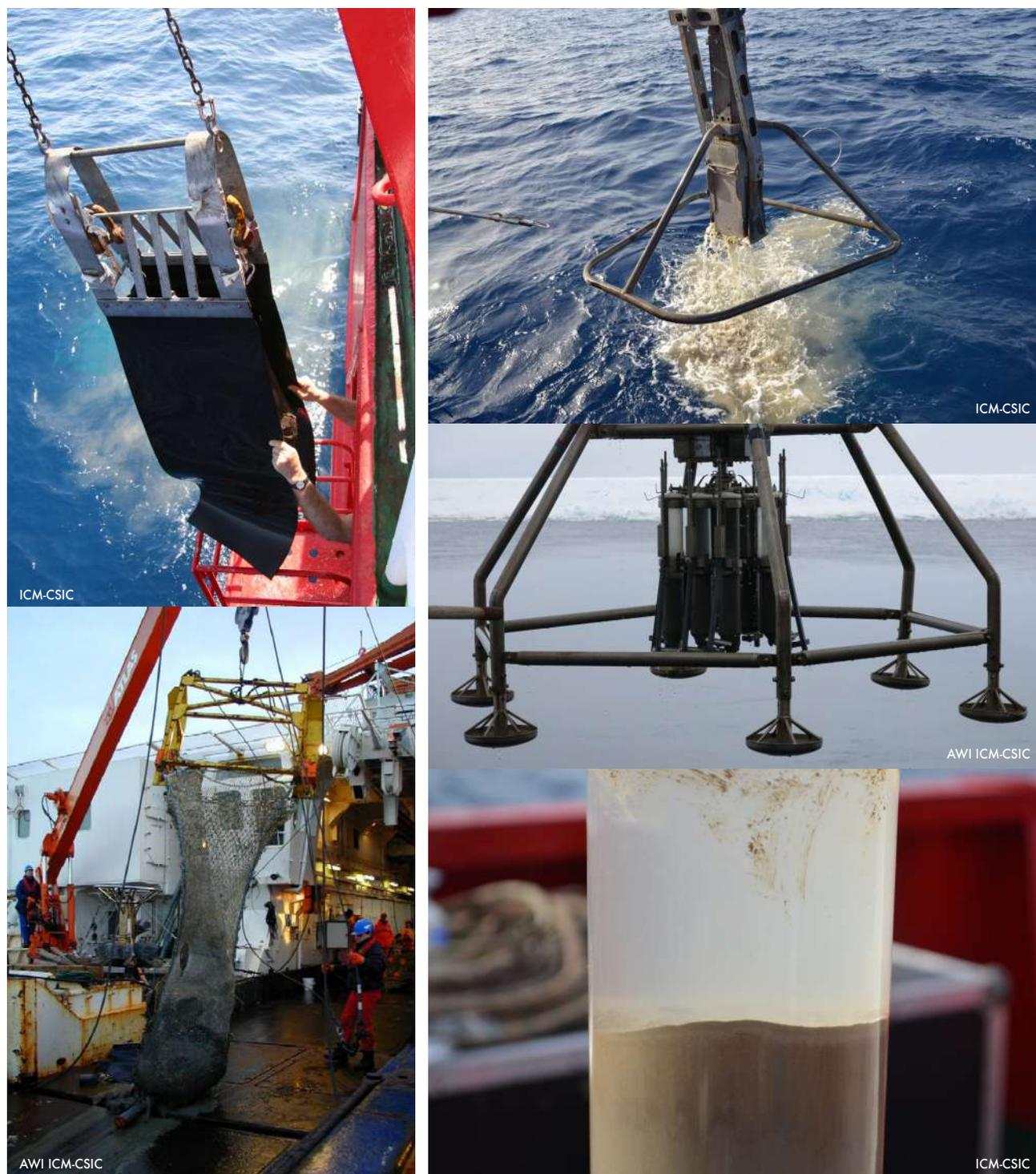
**Fig. 5.** (izq.) Los patines epibentónicos ( $\uparrow$ ) y las redes como esta Agassiz ( $\downarrow$ ) aún se usan para la recogida de muestras biológicas del fondo marino. (der.) Para tomar muestras de sedimento, existen distintos aparatos que se clavan en el mismo para extraer muestras; algunos permiten también estudiar la interfase entre el agua y el sedimento.
