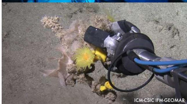
**Fig. 8.** El sumergible *JAGO* es usado actualmente en numerosos estudios sobre el fondo marino. En las imágenes se puede observar la secuencia desde que el sumergible está sobre el buque oceanográfico hasta que se encuentra dentro del agua; cuenta con un brazo mecánico para la toma de muestras puntuales.
