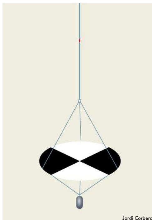
**Fig. 1.** Disco de Secchi, que permite estimar la profundidad de la zona fótica.
