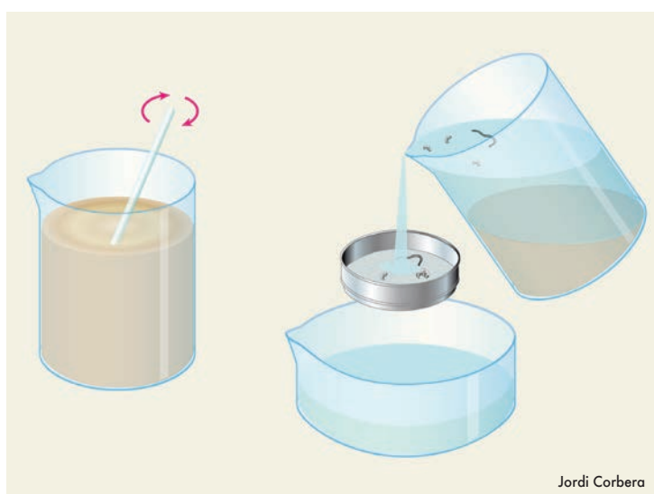
Fig. 21. Representación de cómo realizar la resuspensión de la muestra con una varilla de cristal (←) y la decantación del sobrenadante a través de una malla (→).
