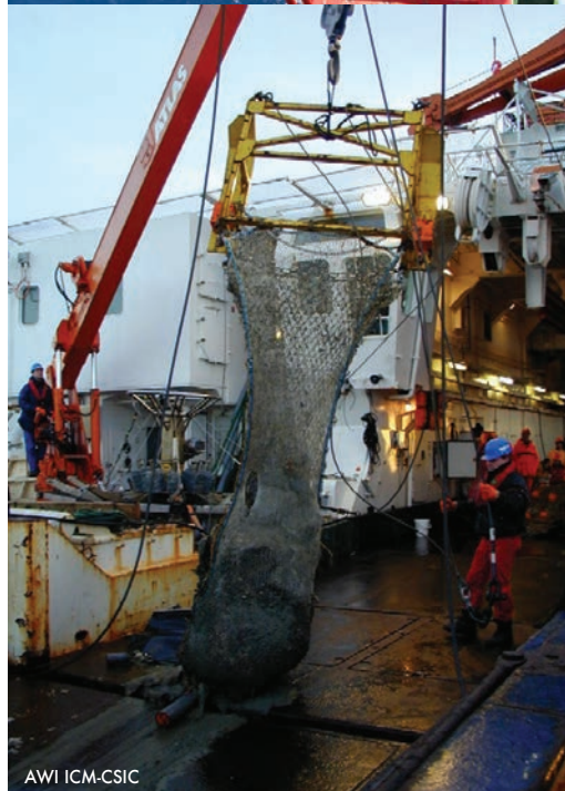
Fig. 5. (esq.) Els patins epibentònics (↑) i les xarxes com aquesta Agassiz (↓) encara s'utilitzen per a la recollida de mostres biològiques del fons marí. (dreta) Per prendre mostres de sediment hi ha diferents aparells que s'hi claven a fi d'extreure-les; alguns permeten també estudiar la interfase entre l'aigua i el sediment.
