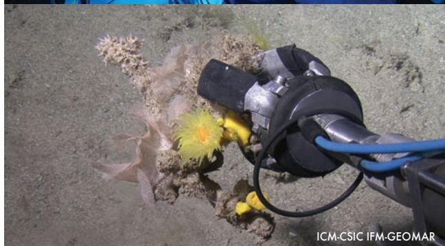
Fig. 8. El submergible JAGO és emprat actualment en nombrosos estudis sobre el fons marí. A les imatges es pot observar la seqüència des que el submergible està sobre el vaixell oceanogràfic fins que es troba dins de l'aigua; està equipat amb un braç mecànic per prendre mostres puntuals.
