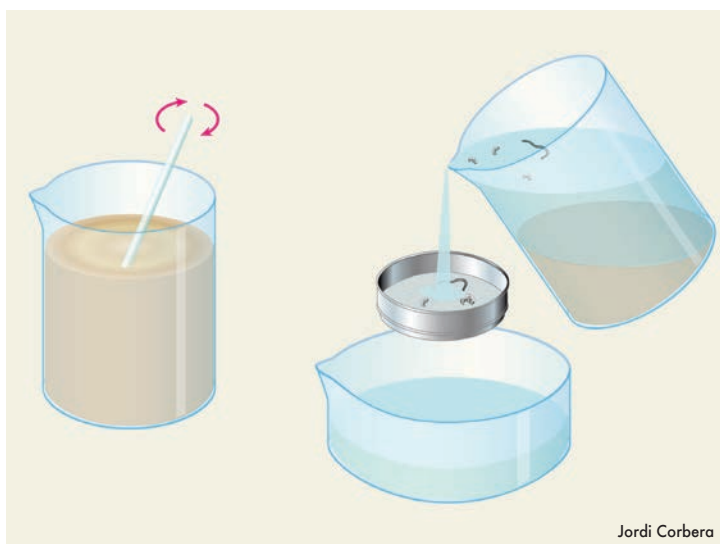
Fig. 21. Representació de com fer la resuspensió de la mostra amb una vareta de vidre (←) i la decantació del sobrenedant a través d'una malla (→).
